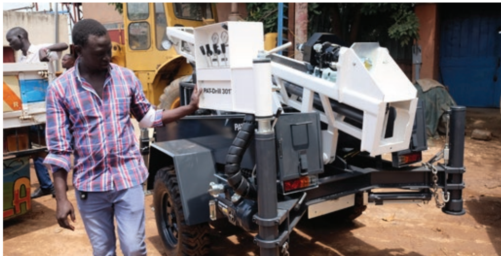
Nowoczesna wiertnica jest w stanie dotrzeć w trudno dostępne miejsce i w krótkim czasie wykonać odwiert nawet na 80 metrów głębokości, Sudan Południowy 2018, Fot. PAH
